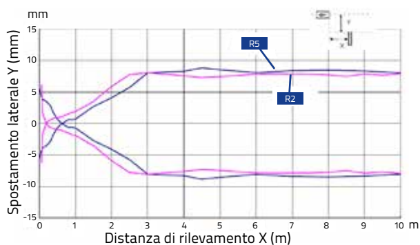
SBARRAMENTO POLARIZZATO - AREA DI RILEVAZIONE
